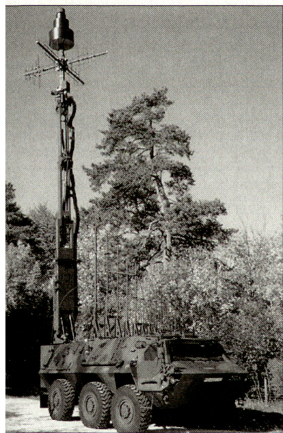
Mobiles Störsystem «Hummel» auf einem Schützenpanzer «Fuchs» bei der deutschen Bundeswehr.
