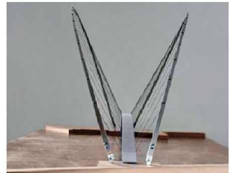
01 Schmetterlingsbrücke – ein neuartiger Öffnungsmechanismus (Foto: Lee Franck)
