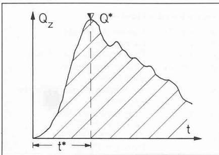
Bild 2. Typische Zufluss-Ganglinie  $Q_z(t)$  für einen Speicher mit ausgeprägtem Spitzenabfluss  $Q^*$  und zugehöriger Zeit  $t^*$ , die vom Beginn des Ereignisses bis zum Erreichen von  $Q^*$  verstreicht
