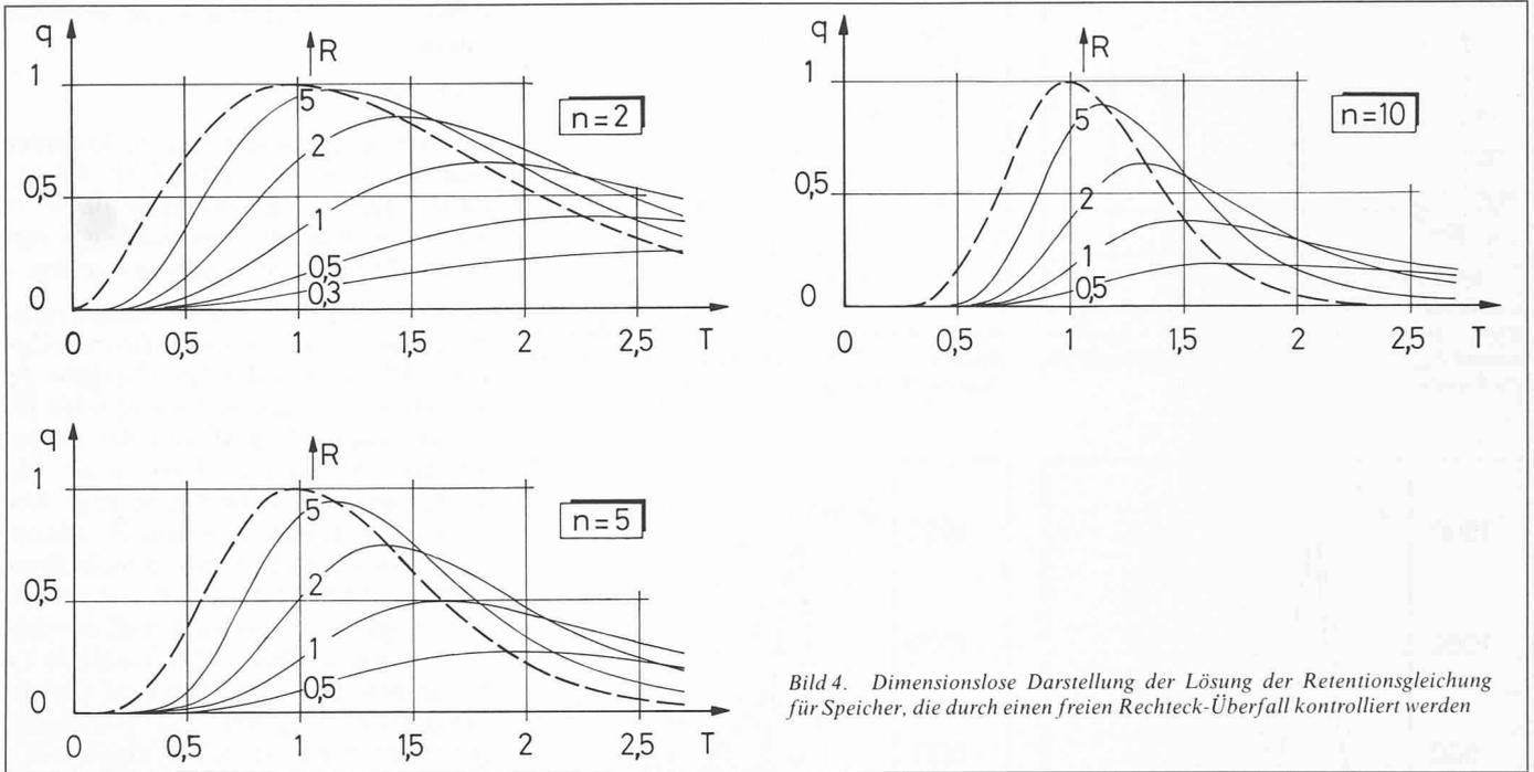
Bild 4. Dimensionlose Darstellung der Lösung der Retentionsgleichung für Speicher, die durch einen freien Rechteck-Überfall kontrolliert werden
