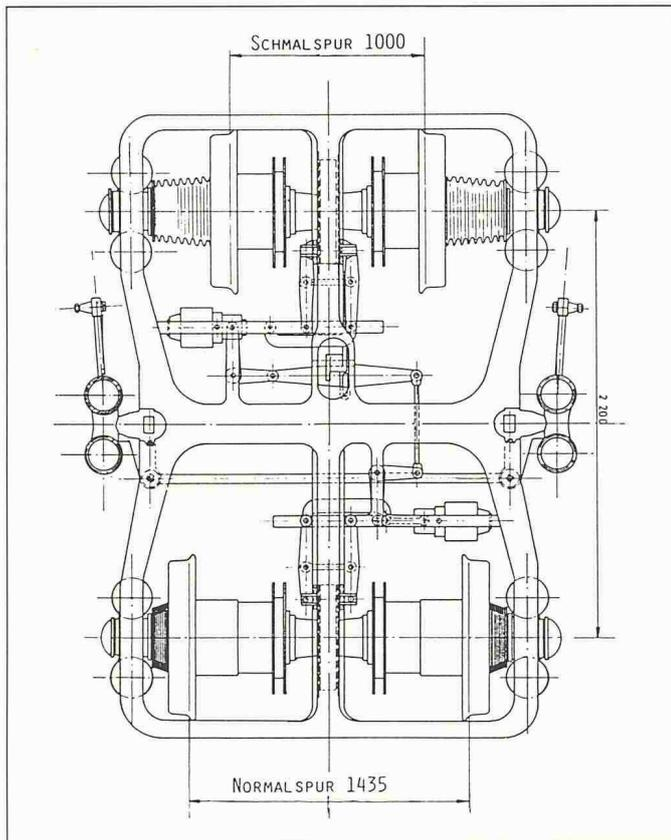
Bild 1. Plan zu einem mit umspurbaren Radsätzen ausgerüsteten Drehgestell
