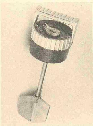
Konsistenzmessgerät Plastimeter P 86
