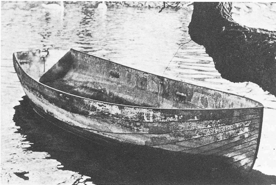
Bild 1. 80 Jahre nach seiner Herstellung war im Jahre 1967 dieses Ferrozementboot im Amsterdamer Zoo noch immer wassertüchtig («Cement», Amsterdam, The Netherland)
