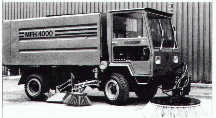
**MFH 4000** die neue leistungsstarke Kehrmaschine, Geschwindigkeit stufenlos 0–60 km/h, auf gefedertem Chassis mit Allrad-Antrieb und Allrad-Lenkung. Meili-VM-Dieselmotor, Fassungsvermögen Schmutztank 4000 l, Wassertank 700 l, Gesamtgewicht 7000 kg. Kann als Dreiseiten-Kipper, Transporter und Winterfahrzeug eingesetzt werden.
