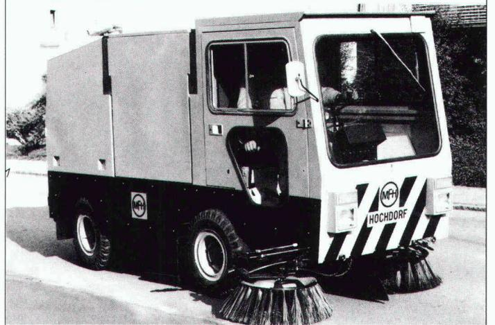
**MFH 2100** die bewährte Kehrmaschine, Arbeitsgeschwindigkeit stufenlos 0–25 km/h, 2,4 l Ford-Dieselmotor, Fassungsvermögen Schmutzbehälter 1600 l, Wassertank 500 l, sehr schmal (Gesamtbreite 125 cm).
