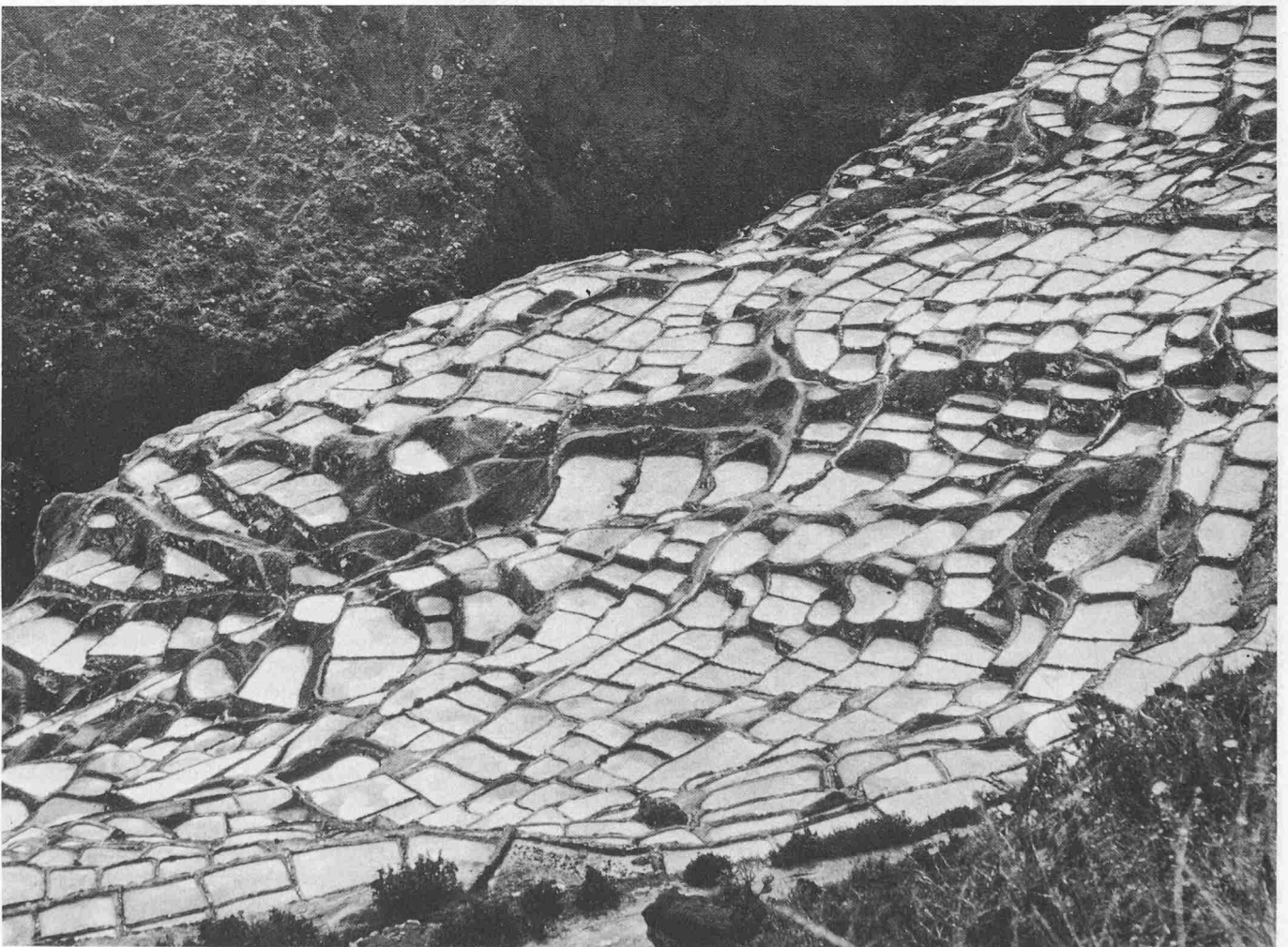
Eine alte Anlage zur Gewinnung von Salz unweit von Cuzco. Auf 3500 Meter Höhe wird das salzhaltige Quellwasser in tausende von Becken von Zimmergrösse geleitet. Weil das Wasser nicht johdaltig ist, wird das Salz gegenwärtig nur noch für das Vieh verwendet
