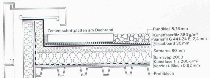
Schichtaufbau eines Sarnafil-Flachdaches auf Profilblechen
