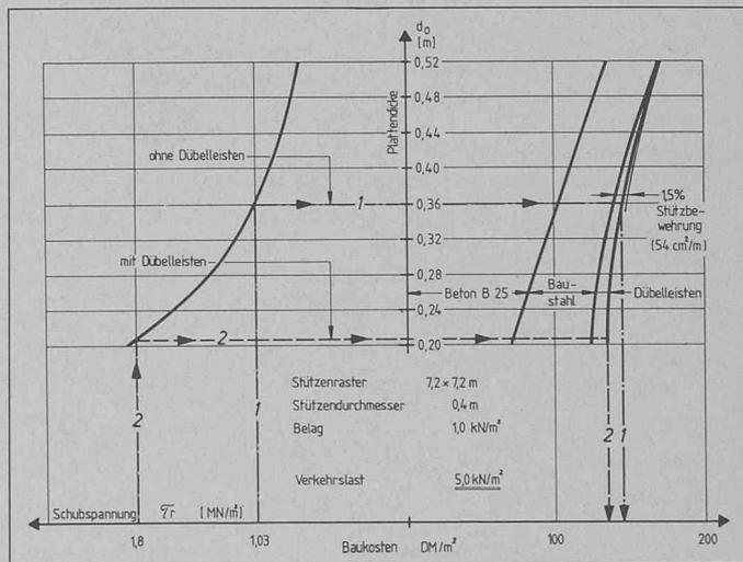
Bild 1. Linienzug 1-1. Plattendicke und zugehörige Baukosten, bei der ausser dem hohen Bewehrungsgrad von  $\mu_g = 1,5\%$  gerade noch keine besonderen Massnahmen für die Sicherheit gegen Durchstanz erforderlich sind, wobei  $\tau_{zul} = 1,3 \cdot 1,3 \cdot \sqrt{1,5} \cdot 0,5$  [MN/m²]
