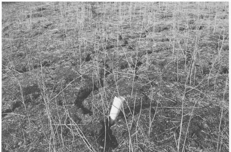
Bild 7. Schwarzer Ton mit Schrumpfrissen
