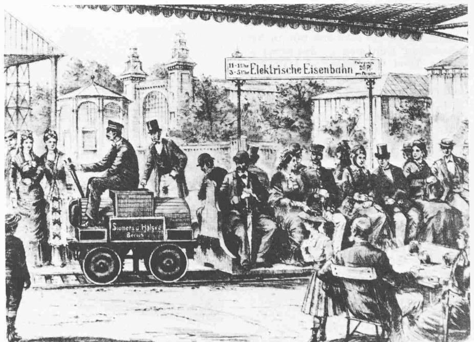
Auf dem Gelände der Berliner Gewerbeausstellung setzte sich am 31. Mai 1879 zum erstenmal ein Schienenfahrzeug mit Hilfe von Strom und Elektromotor in Bewegung. Werner von Siemens hatte diese erste elektrische Lokomotive der Welt konstruiert. Sie zog drei kleine sechssitzige Wagen über eine 300-Meter-Rundstrecke. Der geglückten Premiere vom 31. Mai folgten während der Dauer der Ausstellung noch rund 5000 weitere Fahrten
