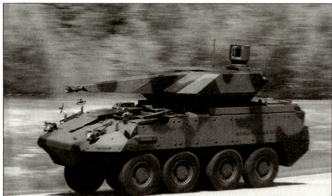
Geschützversion 35 mm des «Skyranger» auf einem Schützenpanzer «Piranha III».
