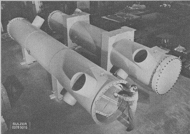
Deux des quatre échangeurs de chaleur pour le refroidissement du circuit intermédiaire dans un réacteur à eau bouillante (matériau des tubes: CuZn28Sn; surface de refroidissement par unité: 73 cm<sup>2</sup>).
