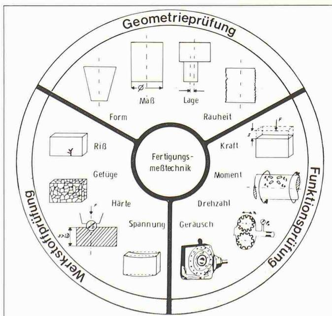
Bild 1. Gebiete der Fertigungsmesstechnik (Quelle: WZL TH Aachen)
