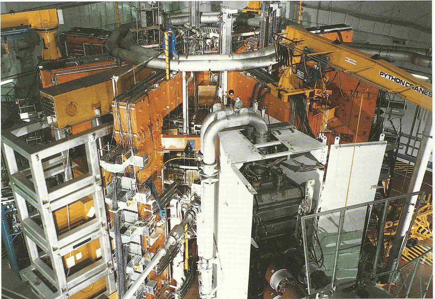
Bild 9. JET Gesamtansicht. Im Vordergrund erkennt man einen der Neutralteilcheninjektoren
