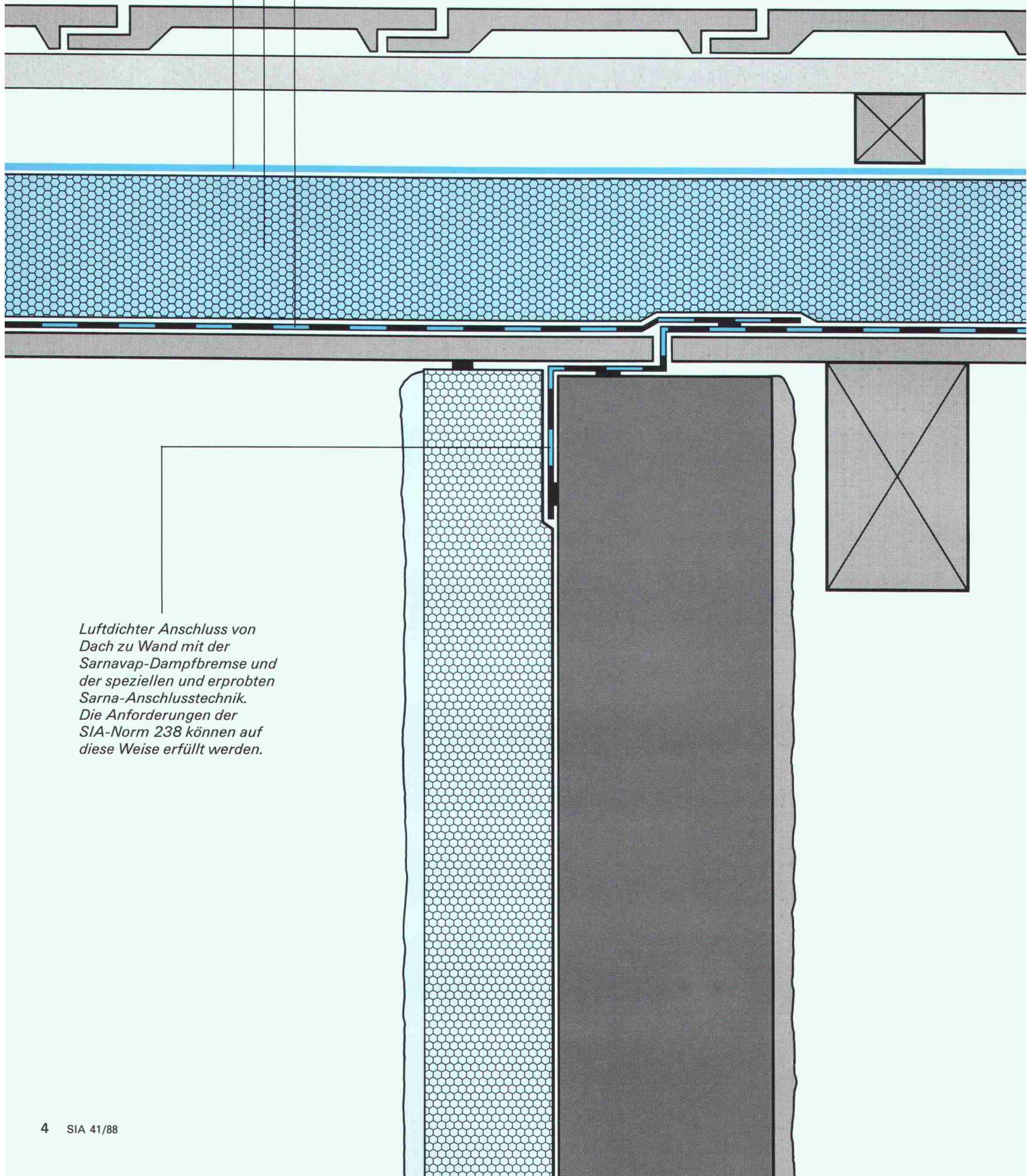
*Luftdichter Anschluss von Dach zu Wand mit der Sarnavap-Dampfbremse und der speziellen und erprobten Sarna-Anschluss-technik. Die Anforderungen der SIA-Norm 238 können auf diese Weise erfüllt werden.*
