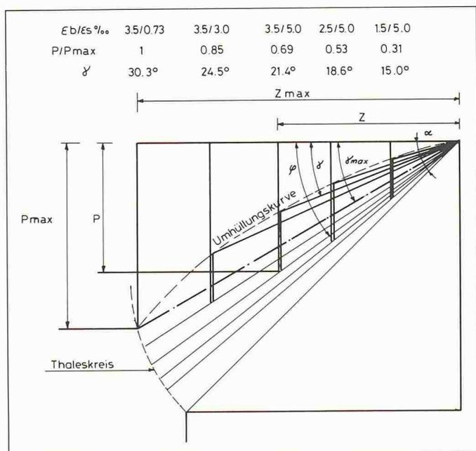
Bild 6. Zusammenhang zwischen  $P_{\max}$ ,  $P$ ,  $\phi$ ,  $\gamma$ ,  $\gamma_{\max}$
