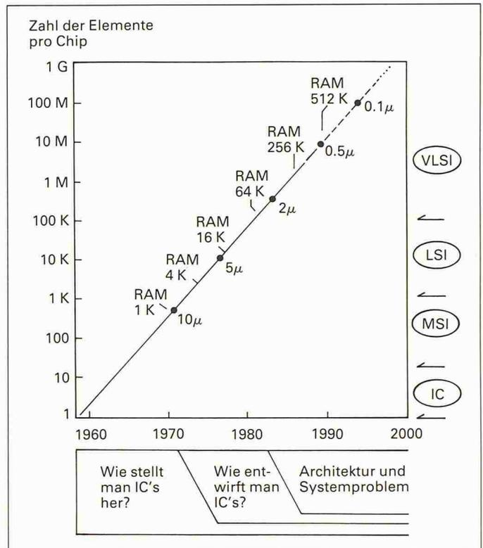
Bild 5. Komplexität integrierter Bausteine in der Mikroelektronik
