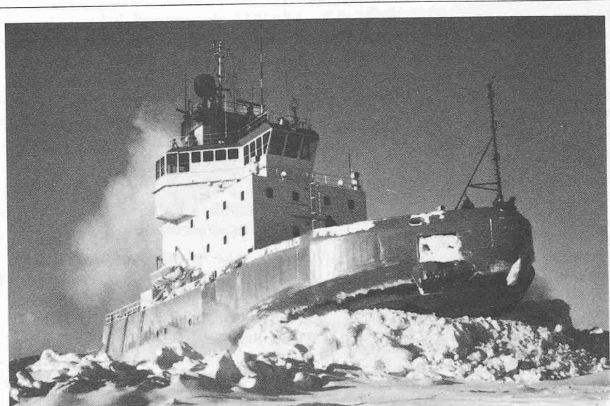
Arktis-Versuchseisbrecher «Kigoriak», angetrieben von zwei Sulzer-Motoren Typ 12ZV40/48
