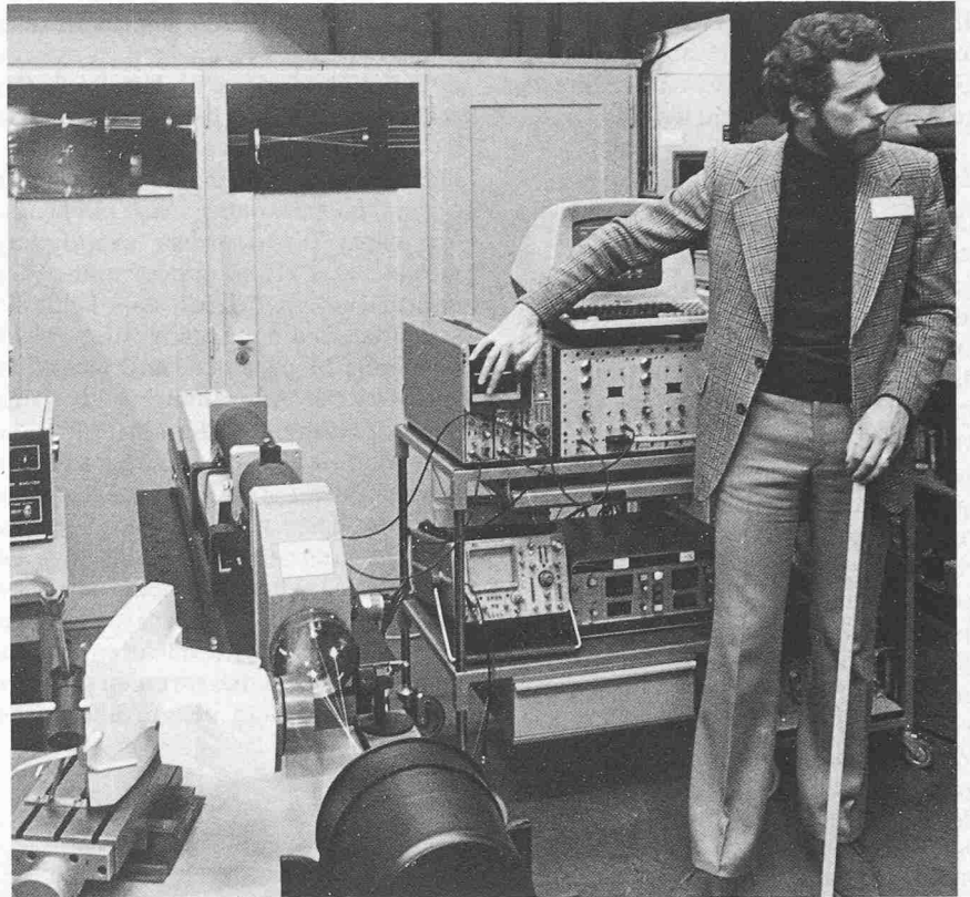
Die Methode der Laser-Doppler-Anemometrie wurde in einer Demonstration mit Hilfe eines gewöhnlichen Ventilators (im Bild links vorne) veranschaulicht. Rechts neben der Laser-Apparatur (Bildmitte) ist die Auswertelektronik aufgebaut.
