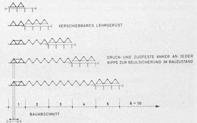
Bild 13. Paketumschlaghalle München, Schema der Bauausführung in 10 Bauabschnitten
