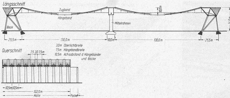
Bild 17. Wartungshalle V, Frankfurt, Längs- und Querschnitt
