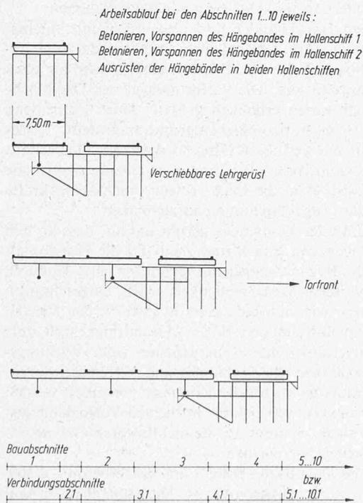
Bild 21. Wartungshalle V, Frankfurt, Schema der Bauausführung der Dachfläche in 10 Bauabschnitten
