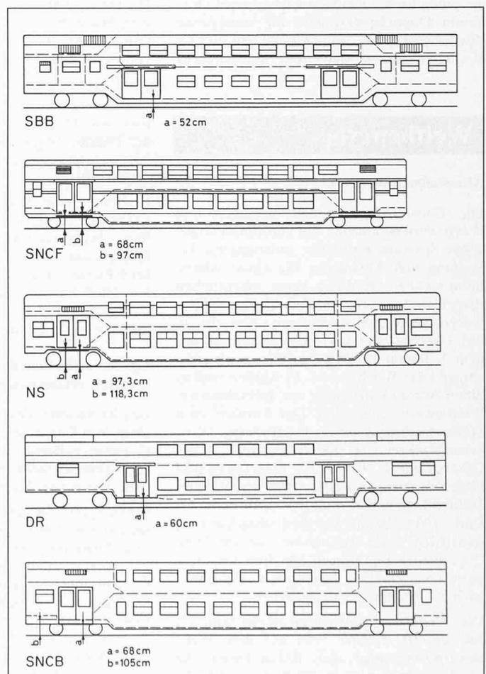
Tabelle 1. Der geplante Doppelstockwagen der SBB im Vergleich mit den entsprechenden Fahrzeugen der Bahnen in Europa
