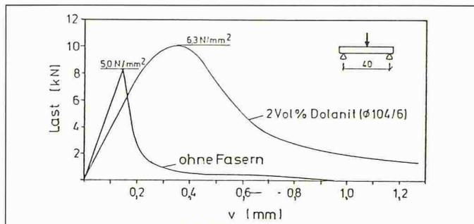
Bild 5. Last-Verformungsverhalten bei Biegezugprüfung
