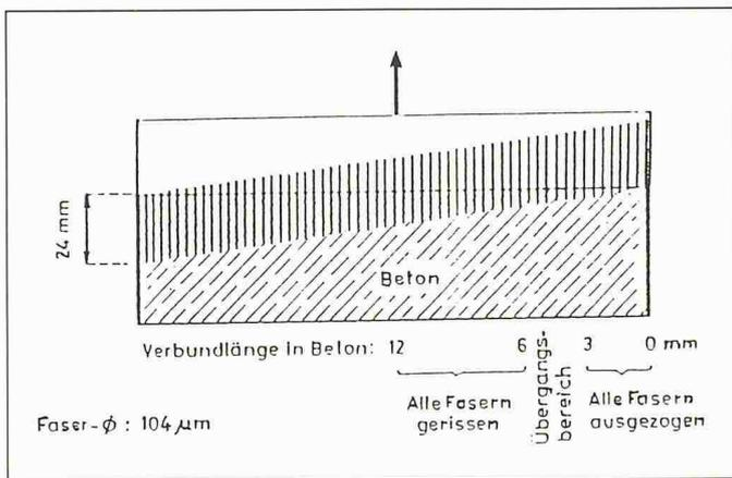
Bild 2. Prüfung des Verbundverhaltens
