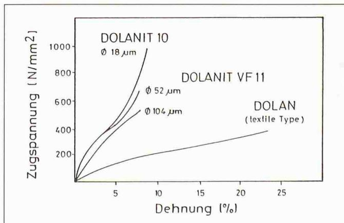
Bild 1. Spannungs-Dehnungs-Diagramm
