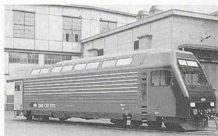
S-Bahn-Lokomotive Re 4/4 V der SBB
