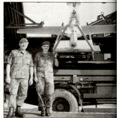
Startgerät für die Aufklärungsdrohne KZO (Kleinflugzeug-Zielortung).
