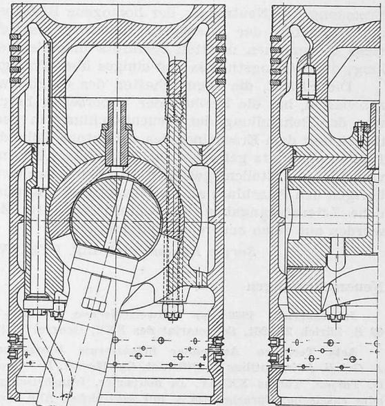
Bild 1. Kolben eines MaK-Zweitakt-Dieselmotors
