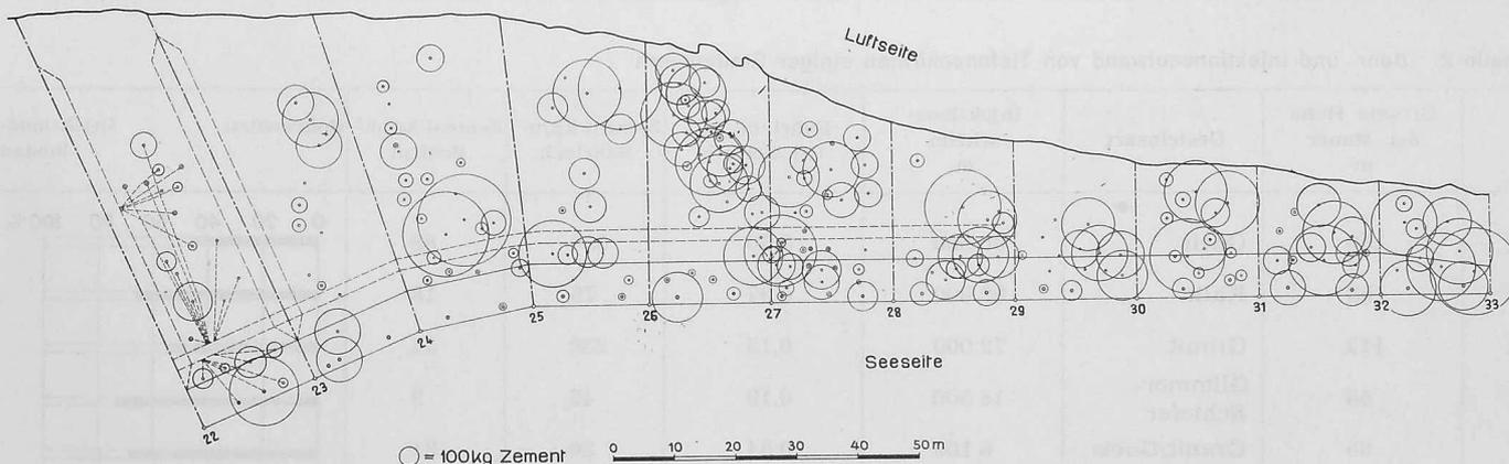
Bild 7. Staumauer Albigna. Kontaktinjektionen der Blöcke 22 bis 32
