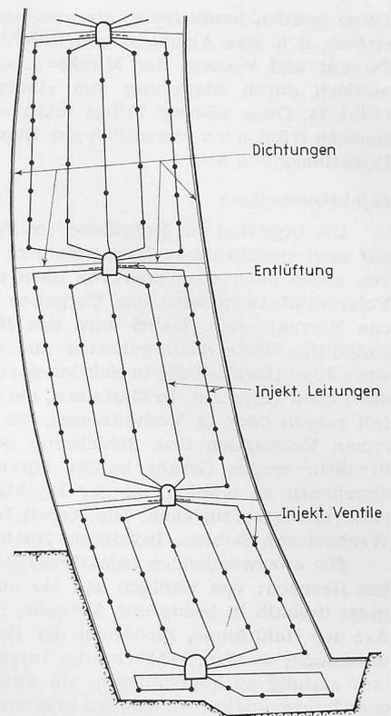
Bild 8. Injektionsschema einer Staumauerfuge
