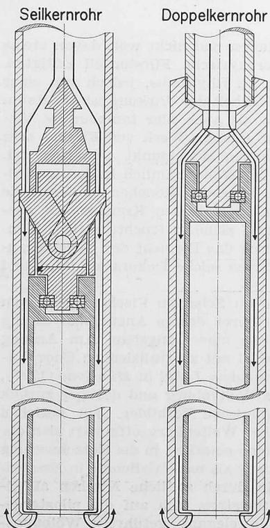
Bild 1. Kernbohrrohre, Schemaskizzen
