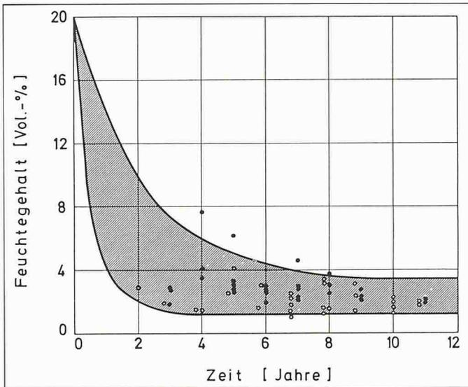
Bild 1. Zeitlicher Verlauf des mittleren Feuchtegehalts von Gasbeton-Aussenbauteilen (Wände, Flachdächer)
