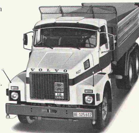
**Volvo N12 Dreiseiter:** Gesamtgewicht 25 t, Fahrgestellgewicht inkl. elektr. Wirbelstrombremse ca. 8,2 t. **Mit Breitreifen 2,5 m Breite.** Mit Doppelbereifung 2,5 m Breite. Spurbereich 15,4 m. Vollganzstahl-Sicherheitskabine. Motorhaube/Kotflügel aus glasfaserverstärktem Kunststoff. Volvo-Dieselmotor mit Abgasturbolader, 330 DIN/PS, Volvo-16-Gang-Getriebe. Auf Wunsch mit automatischem Getriebe.
