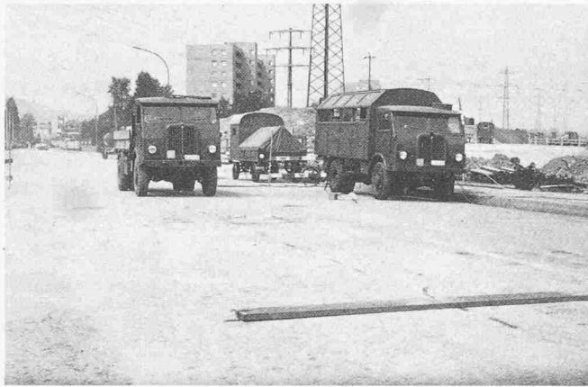
Bild 4. Das Fahrzeug links diente als Versuchsfahrzeug. Im Vordergrund ist das für «Sprungversuche» bereitgelegte Brett sichtbar The vehicle left served as the test vehicle. In the foreground is the board laid ready for the «bump test»
