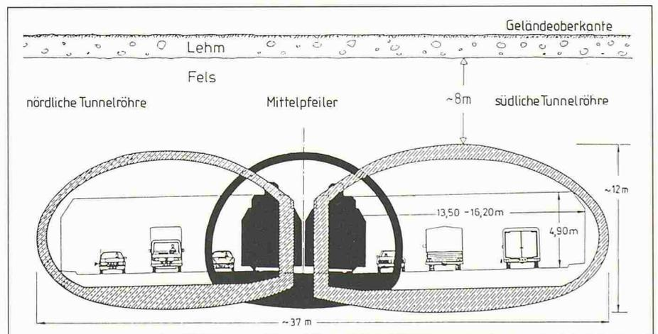
Bild 2. Flachliegender Strassentunnel unter dem Hahnerberg bei Wuppertal: Vergleich der Querschnittsabmessungen mit denen eines zweigleisigen Eisenbahntunnels der Neubautrecken der Deutschen Bundesbahn (Wittke)
