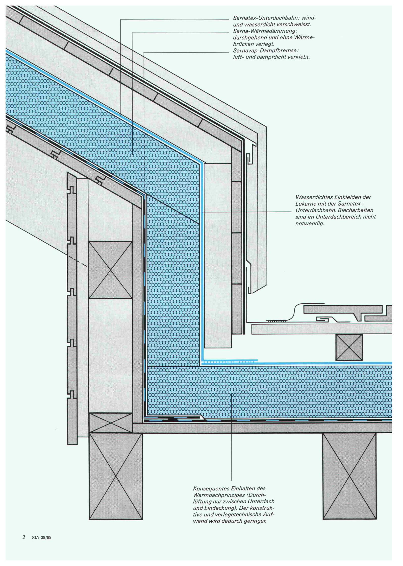
*Sarnatex-Unterdachbahn: wind- und wasserdicht verschweisst.
