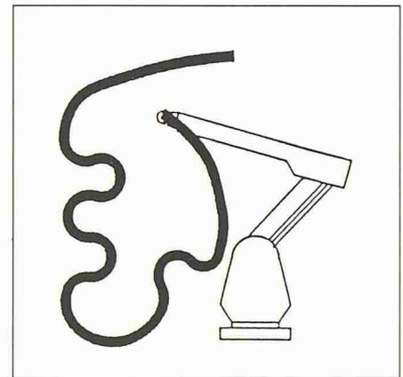
Bild 3. Roboter-Bahnsteuerung
