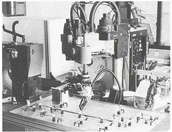
Bild 18. Versuchsaufbau zur Kabelbaummontage. (Werkbild IPA)
