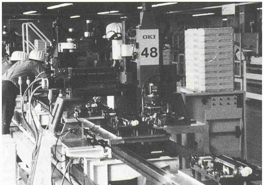
Bild 23. Automatisches Montagesystem für Drucker (Werkbild OKI-DATA)
