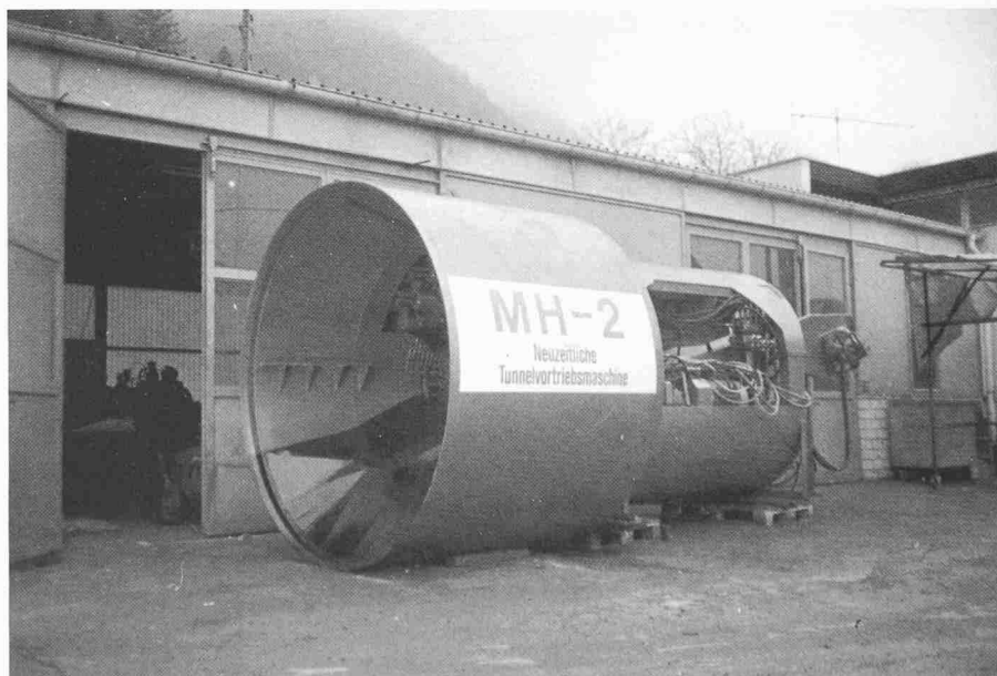
Nachlaufrohr (Power unit)
