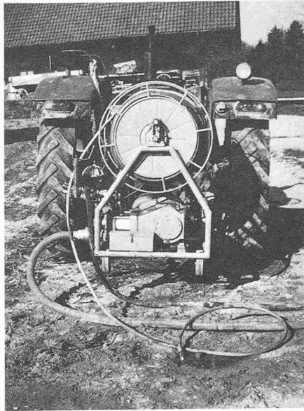
Bild 2. Angebautes Dränpülgerät «Fricke» am Dreipunktgestänge des Traktors
