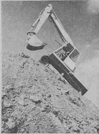
Für den Einsatz als Tieflöffelbagger sind drei verschiedene Ausleger mit maximalen Reichweiten von 7,54 m, 8,69 m und 9,14 m verfügbar. Die Maschine ist daher praktisch allen Arbeitsbedingungen gewachsen. Sie kann mit den verschiedensten Aushubschaufeln bis zu einem Fassungsvermögen von 600 l bestückt werden. Der 108S mit 5,951 Sechszylinder-Dieselmotor (wassergekühlt) leistet 90 PS bei 2100 U/min.
