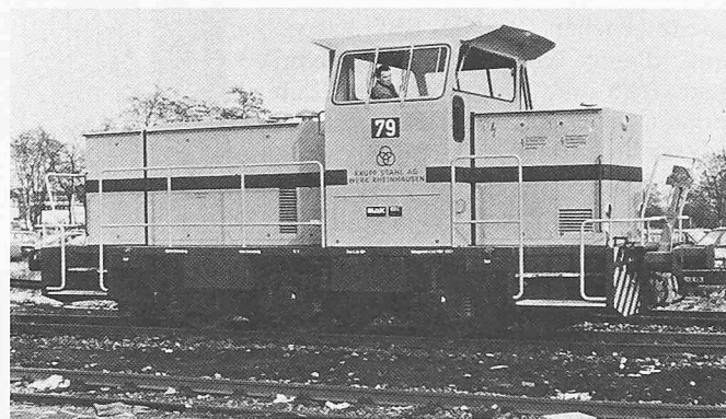
Bild 10. Diesel-Industrie-Rangierlokomotive DE 500, 500 kW Leistung
