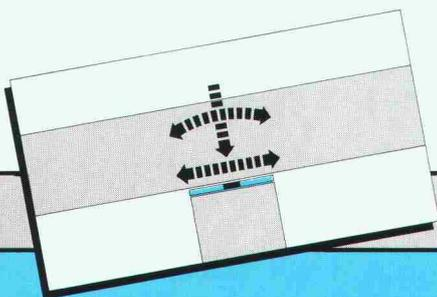
Gleit- und Deformationslager mit den Funktionen Lastaufnahme, Rotation und horizontales Gleiten
