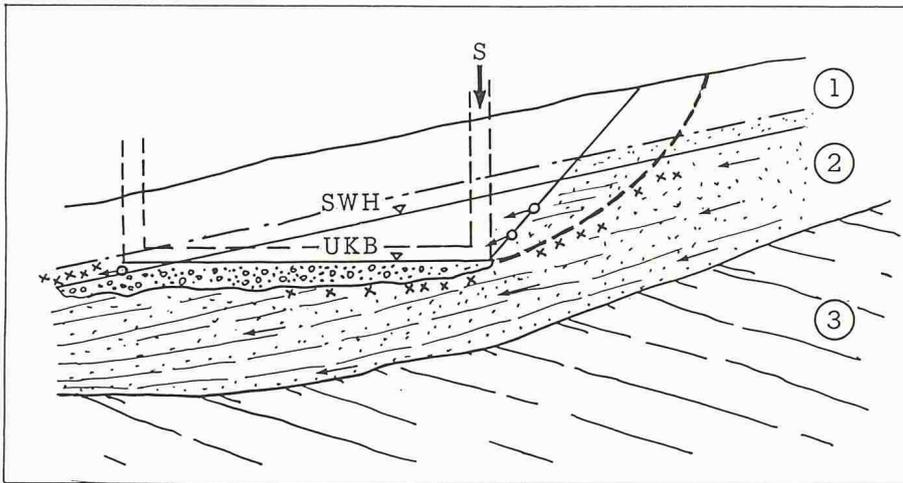
Bild 6. Gegenüberstellung eines Bauvorhabens mit gegebener Sickerwassersituation. SWH = Sickerwasserhorizont, UKB = Unterkante Bauwerk, 1 = Verwitterte Deckschicht, 2 = Randeiszeitliches Schwemmsediment, 3 = Molasse-Sandstein, ××× = Feinstofftransport
