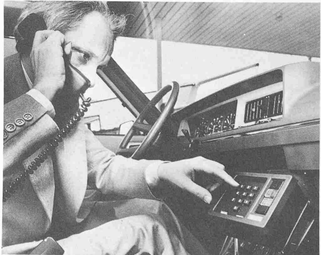
Natel-Mobilstation, eingebaut in Fahrzeug
