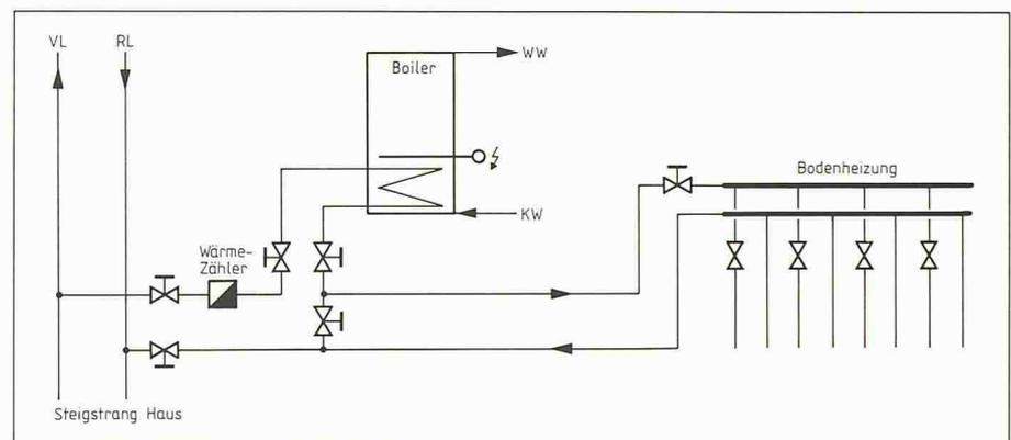
Bild 2. System installiert in Winterthur: Anschluss des Boilers an das Heizungsnetz mit manueller Umschaltung von Sommer- auf Winterbetrieb. (Damit kann der Boiler auch im Sommer mit der Wärmepumpe aufgeheizt werden. Die Bodenheizung bleibt ausgeschaltet)
