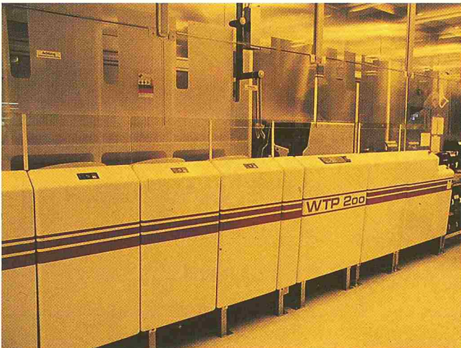
Bild 6. Die Reinigungsstation WTP (Wet Tank Processor) dient dem nasschemischen Prozessieren von Siliziumscheiben. Ein Roboter transportiert die Fertigungslose durch eine Reihe von Prozess tanks mit ätzenden oder Lack entwickelnden Chemikalien. Danach werden die Wafer mit Wasser gespült und in Schleudertrommeln getrocknet
