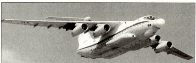
**Versuche mit dem russischen flugzeuggestützten Laser, der für Raketenabwehr vorgesehen ist.**
