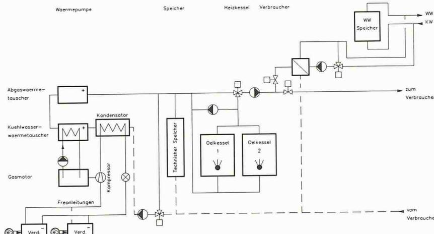
Prinzipschema der Anlage: Gasmotorwärmepumpe mit Luft als Wärmequelle, bivalent alternativ (-3 °C), Heizleistung 143.2 kW (TA = -5 °C, TVORL. = 54 °C), Heizziffer 1.4, Heizleistung 189.4 kW (TA = + 5 °C, TVORL. = 43 °C), Heizziffer 1.79
