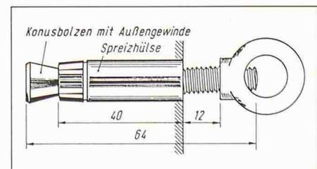
Bild 3. Edelstahlanker zum Verdübeln einer Sanierungsschicht aus Stahlfaserspritzbeton
