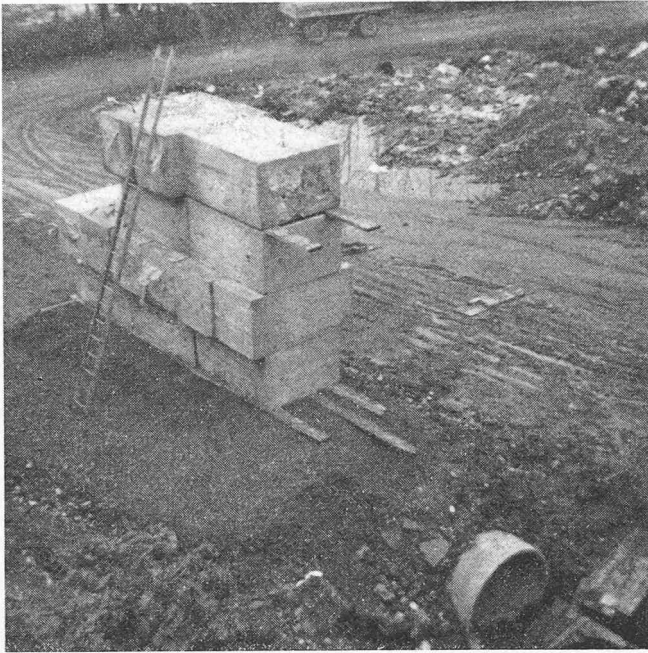
Bild 8. Feldversuch, Dauerbelastung 3 Tage
