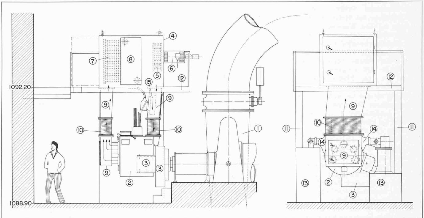
Bild 11. Zubringerpumpengruppe mit Fremdbelüftung- und Kühlaggregat
