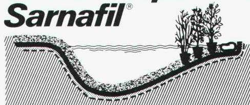
Die grüne Sarnafil-Kunststoff-Dichtungsbahn wurde speziell für die Abdichtung von Teichen und Biotopen geschaffen. Sie genügt den hohen Anforderungen (mechanische Beanspruchung, Wurzelbeständigkeit usw.) und passt sich der natürlichen Umgebung farblich an. Sarnafil-Abdichtungsbahnen werden nach Mass im Werk (bis ca. 80m<sup>2</sup>) angefertigt, bei grösseren Anlagen auf der Baustelle.
