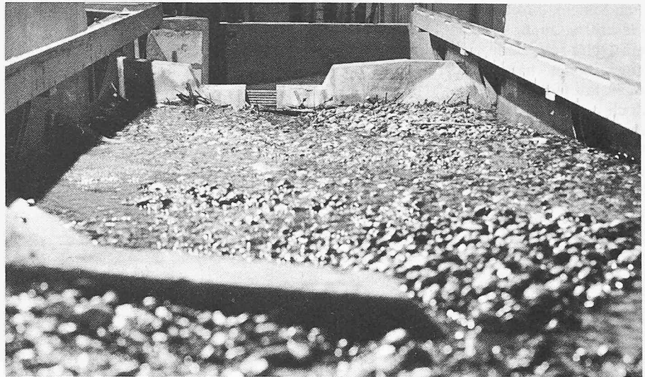
Bild 5. Endstadium nach Versuch 80 (Beschickung von insgesamt 200 000 m 3 Geschiebe). Blick von 150 m oberhalb der Sperre bachabwärts
