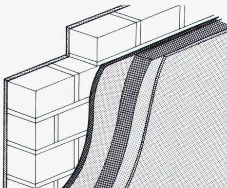
Schon 18 Jahre hält nun rhodipor-Dämmputz, was wir versprechen: Besten Wärmeschutz ( $\lambda = 0.056 \text{ W/m K}$ , Rechenwert nach SIA-Norm 279), keine Kondens-
