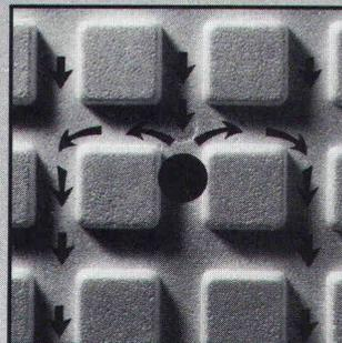
Die Anordnung der Auflagenoppen lässt auch bei einem eventuell verstopften Sickerkanal das Wasser seitwärts abfließen. Formschaumung sorgt für Massgenauigkeit und Wasserresistenz. Sie sind alterungs- und fäulnisbeständig. Kurz, der Wasserschutz rund ums Haus.
